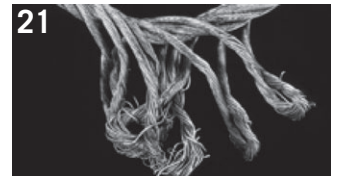
21 Dieses Drahtseil wurde aufgedreht. Hier sind die Außenlitzen zu lang für das Seil. Eine Seilscheibe hat die Überlänge zu einem Punkt hin massiert, wo die Außenlitzen nun hochstehen.
