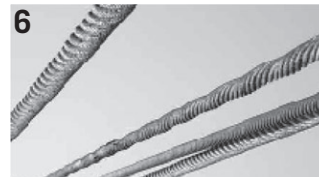
6 Korkenzieher können sich bilden, wenn Seile an Konstruktionsteilen reiben oder durch zu enge Seilrillen gezogen werden.
