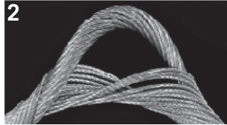
2 Durch Verdrehung im seilzudrehenden Sinn wurde dieses drehungsarme Seil verkürzt und seine Stahleinlage verlängert
