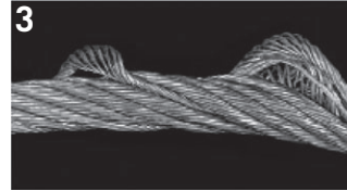
3 Doppelparallelseile reagieren empfindlich auf Verdrehung. Hier wurden die inneren Litzen verlängert und herausgedrückt.
