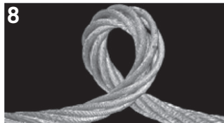
8 Dieses Seil wurde im seilaufrühenden Sinn verdreht. Im unbelasteten Zustand bildet das Seil eine Schlaufe im seilzudrehenden Sinn. Wenn das Seil anschließend belastet wird, kann sich die Schlaufe zuziehen und das Seil bleibend verformen.
