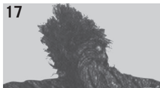
17 Klanken entstehen, wenn eine ösenförmige Seilschlinge gerade gezogen wurde.
