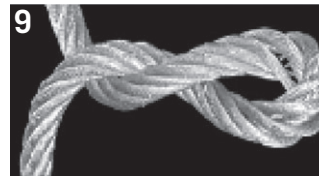
9 Dieses Seil wurde im seilzudrehenden Sinn verdreht. Im unbelasteten Zustand bildet das Seil eine Schlaufe im aufzudrehenden Sinn.
