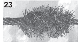
23 Schließseil eines Greiferkrans. Alle Außendrähte sind infolge von starkem Abrieb an der Austrittsdüse 1x pro Schlaglänge gebrochen. Dann wurden die Bruchstücke zu einem Punkt hin massiert, dem Endpunkt der Bewegung.
