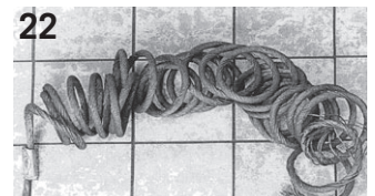
22 Drahtseile, die über eine scharfe Kante gezogen wurden, haben im entlasteten Zustand die Tendenz, sich aufzurollen.
