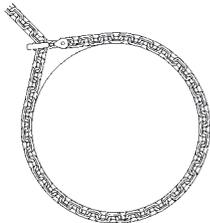
Seilgleitbügel können die max. zulässige Zugkraft herabsetzen.
