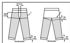
**EN ISO 11393-2:2019, Form C, Klasse 1,** Schutzbereich über die gesamte Vorderseite der Hosenbeine und auf der Rückseite bis zum Gesäß, zusätzlich Schutz des Unterbauches bis ca. 20 cm vom Schnittpunkt nach oben (16 cm bei Größen kleiner M) mit einem Spalt in der Mitte von max. 1 cm. Schutzbereich der Rückseite der Hose bis ca. Schritthöhe. (gilt für Schnitzzschutzhosen der Artikel 49-123, 51-123, 49-160 und Warn-Schnitzzschutzhosen der Artikel 49-221, 49-260)
