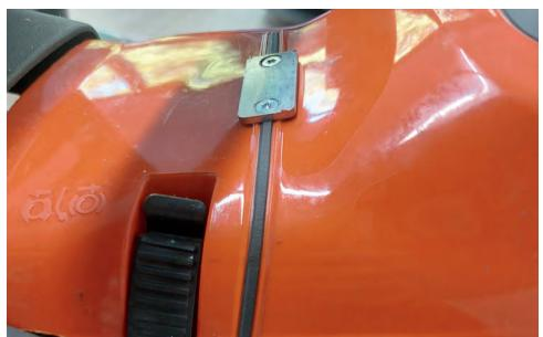
Avec les nouvelles tronçonneuses Husqvarna le marquage de direction d'abattage caoutchouté peut le faire rester sur la tronçonneuse.
