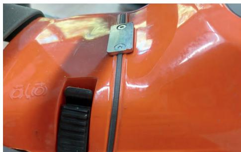
Bei neueren Husqvarna-Motosägen mit gummierten Fällrichtungsmarkierung kann diese an der Motorsäge verbleiben.
