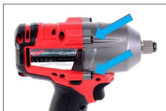
Zum Anbau müssen die beiden an der rechten Gehäusehälfte des Schlagschraubers angebrachten Schrauben demontiert werden.
