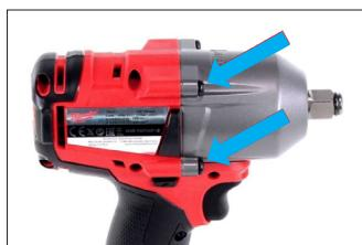
Les deux vis fixées à la moitié droite du boîtier de la clé à chocs doivent être retirées pour l'installation.
