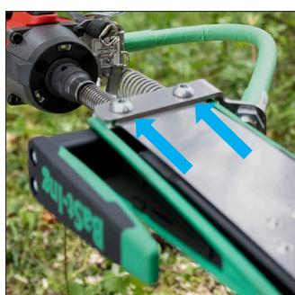
Dans l'étape suivante, démontez la plaque moletée du coin d'abattage afin de monter le support de montage du coin d'abattage (5) à l'aide des vis fournies. Ensuite, appliquez un verrou à vis de résistance moyenne sur les vis pour le montage de la plaque de bouton.
