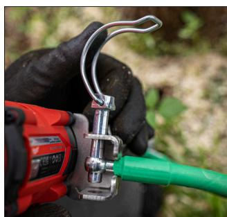
Faites ensuite glisser le ValLink avec la goupille d'arrêt (2) sur la clé à chocs dans la direction du moteur et fixez la fixation de la clé à chocs (3) à la clé à chocs avec les vis que vous avez retirées.
