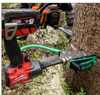
Der ValFix wird entsprechend der Vorgaben in der Anleitung des ValFix in den Baum eingesetzt. Beim Ansetzen ist besonders darauf zu achten, dass der ValFix ausreichend im Baum verankert ist. Es müssen alle Noppen des Spindelkeils im Holz festsitzen, andernfalls kann es vorkommen, dass der ValFix aus dem Schnitt gedrückt wird und der Baum unerwünscht abkippt.
