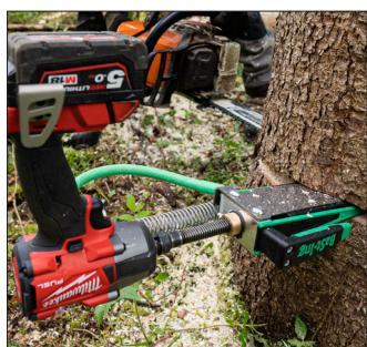
Le ValFix est inséré dans l'arborescence selon les spécifications des instructions ValFix. Lors de l'application, il est particulièrement important de s'assurer que le ValFix est suffisamment ancré dans l'arbre. Toutes les bosses du coin de broche doivent être fermement enfoncées dans le bois, sinon le ValFix peut être poussé hors de la coupe et l'arbre peut basculer.
