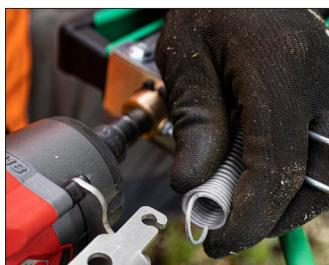
Der Schlagschrauber ist mittels Spannfeder und Klappsplint mit dem ValFix zu verbinden.
