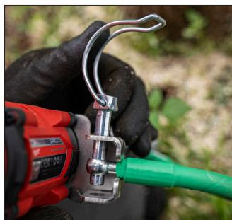
Anschließend den ValLink mit dem Klappsplint (2) in Richtung Motorseite auf den Schlagschrauber schieben und das Anbauteil Schlagschrauber (3) mit den entnommenen Schrauben am Schlagschrauber befestigen.
