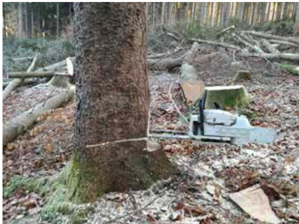
Cette coupe d'abattage est ensuite élargie de quelques millimètres, uniformément vers le haut et le bas. L'image suivante montre un exemple de cet élargissement. Le plus facile pour réaliser cet élargissement est de ressortir un peu la tronçonneuse de la coupe d'abattage, puis de la basculer légèrement vers l'avant. Dans cet angle, la tronçonneuse est repoussée dans l'arbre et la coupe d'abattage est élargie depuis le milieu de l'arbre.
