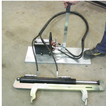
2. Entlüftung: pumpen Sie 2- bis 3-mal auf und ab.
