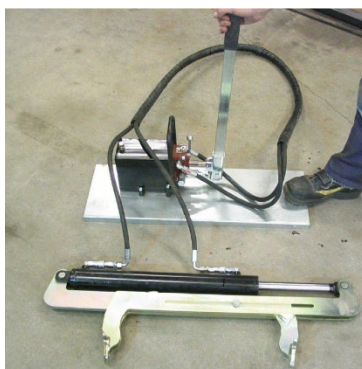
2. Aération : pomper d'avant en arrière 2 à 3 fois.
