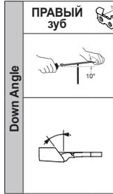
**24.6 РЕГУЛИРОВКА НИЖНЕГО УГЛА (РИС.22)**
