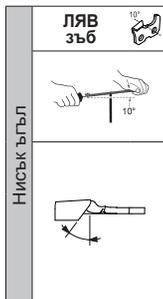
**24.7 РЕГУЛИРАНЕ НА ГОРНИЯ ЪГЪЛ НА ЗАТОЧВАНЕ (ФИГ. 23)**
