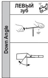
**24.8 РЕГУЛИРОВКА НИЖНЕГО УГЛА (РИС.24)**
