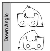
**24.10 REGULACIÓN DEL ÁNGULO DE CORTE (FIG. 21-21A) (dientes derechos e izquierdos)**
