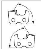
**24.4 РЕГУЛИРАНЕ НА ЪГЛА НА ОТРЯЗВАНЕ (ФИГ. 21-21А) (леви и десни зъби)**
