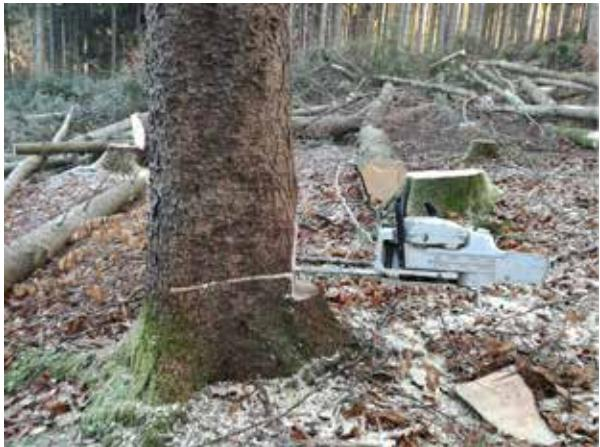
Dieser Fällschnitt wird im Anschluss einige Millimeter, gleichmäßig nach oben und unten aufgeweitet. Das folgende Bild zeigt beispielhaft diese Aufweitung. Diese Erweiterung ist am einfachsten durchzuführen, wenn die Motorsäge im Fällschnitt etwas herausgezogen und anschließend leicht nach vorne gekippt wird. In diesem Winkel die Motorsäge wieder in den Baum schieben und den Fällschnitt aus der Baummitte heraus erweitern.
