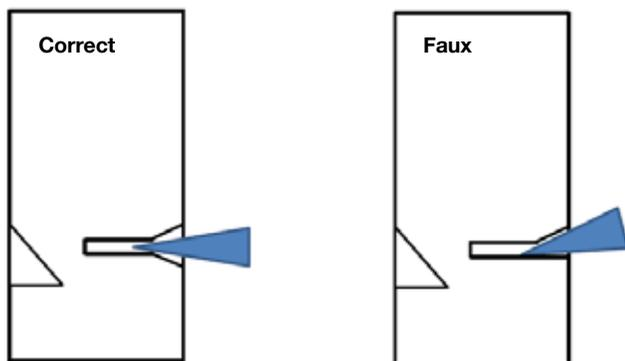
De plus, il faut veiller à ce que les plaques à boutons supérieure et inférieure soient également engagées, sinon l'arbre peut également se plier.
